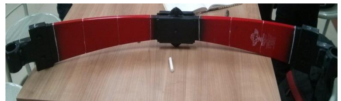
Fig1: Actual Mono Leaf Spring
